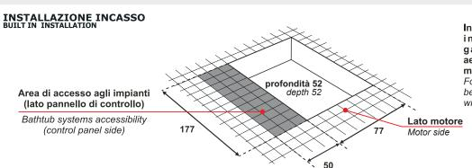
In caso di installazione ad incasso è necessario garantire una corretta aerazione con due griglie min. Ø15cm.
