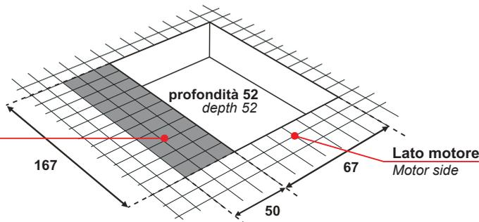
In caso di installazione ad incasso è necessario garantire una corretta aerazione con due griglie min. Ø15cm.
