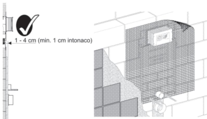
Lasciare una fuga massima di 5 mm tra piastrelle e protezione cantiere.
