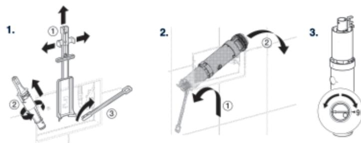
Sostituzione delle guarnizioni
