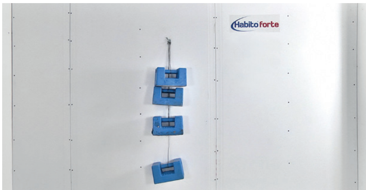
Esempio di applicazione reale di un carico complessivo di 80 kg, mediante una semplice vite da legno truciolare Ø 5 mm, ad un campione di parete realizzato con una singola lastra in gesso rivestito Habito Forte 13 per paramento.
