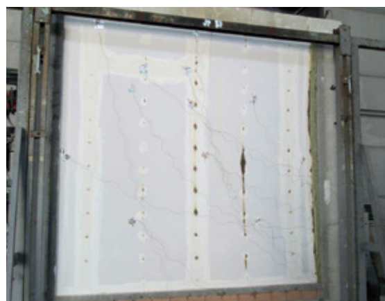
Faccia non esposta al fuoco del campione dopo la prova
