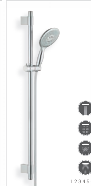
27 737 000 Set asta doccia completo asta 900 mm manopola doccia Ø 130 mm 27 738 000 con GROHE EcoJoy® a 9,5 l/min
