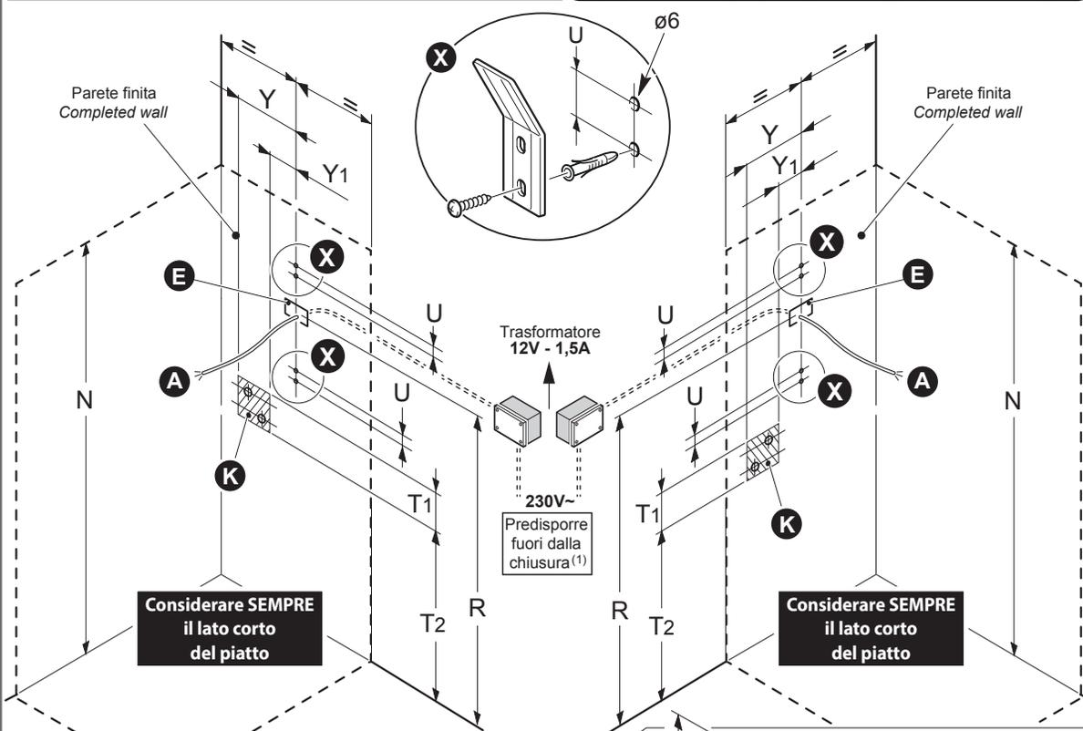
(1) Se si installa un trasformatore in fase di predisposizione occorre bypassare quello fornito con la colonna. Se si utilizza il trasformatore presente sulla colonna occorre spostarlo come indicato in figura (vedere istruzioni di montaggio)
