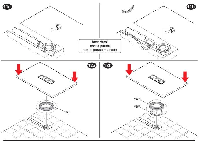
In considerazione della variabilità della tolleranza di spessore del foro della piletta, utilizzare oltre alla guarnizione "A" anche l'anello distanziale "D" nel caso in cui tale spessore non risulteri sufficiente a garantire la corretta stabilita e tenuta della piletta.
