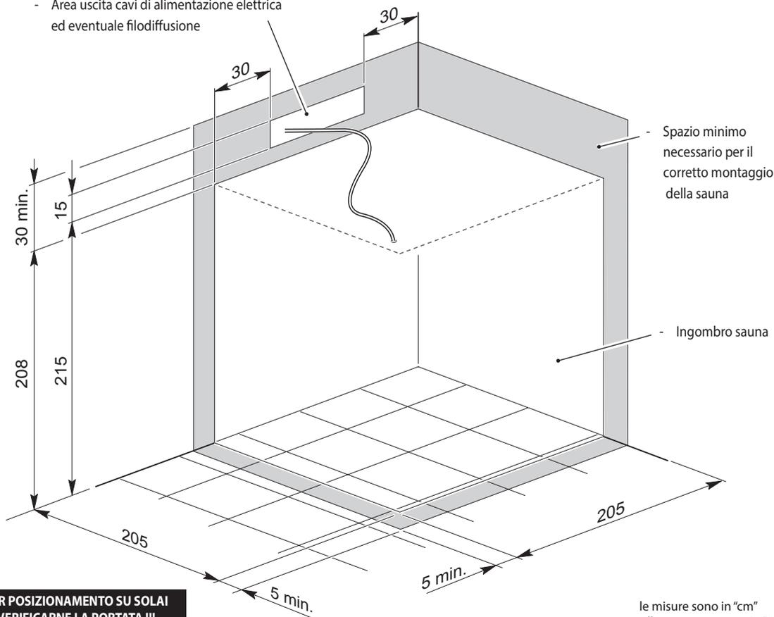
L'impianto elettrico di alimentazione deve essere conforme alla norma IEC 364-1 (CEI 64.8) nonchè alle disposizioni di legge nazionali. Il collegamento elettrico dalla sauna va eseguito in modo fisso e permanente e deve essere protetto da un interruttore differenziale (30mA) e magnetotermico adeguato all'assorbimento del bagno turco (vedere tabella "Dati tecnici") con apertura minima dei contatti di 3mm.
