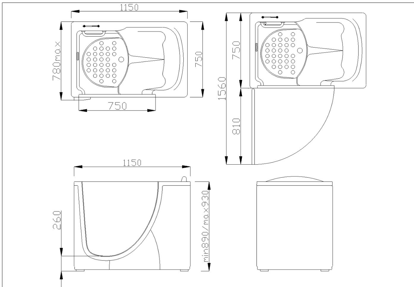
Vasca con porta ad apertura verso l'esterno, munita di maniglia sul corpo vasca, realizzata in VTR. Leva d'apertura laterale. Senza miscelatori
